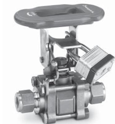
Estão disponíveis manoplas ovais providas de fecho e trava para as válvulas de 2-vias das Séries 63 e 65. As manoplas podem travar as válvulas nas posições aberta ou fechada e acomodam alças de cadeado com diâmetro menor do que 8,3 mm. As válvulas com manoplas ovais providas de fecho e trava não podem ser montadas em painel.
